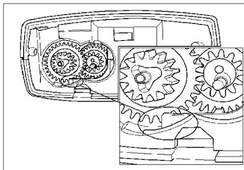
Couper cette languette à l'aide d'une lame très aiguisée afin de libérer la roue dentée endommagée.
