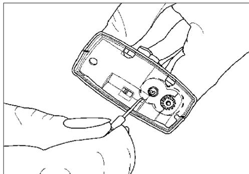
Sur cette vue du boîtier d'engrenages ouvert, la languette dépassant du bouton de déverrouillage empêche la dépose de la roue dentée endommagée.
