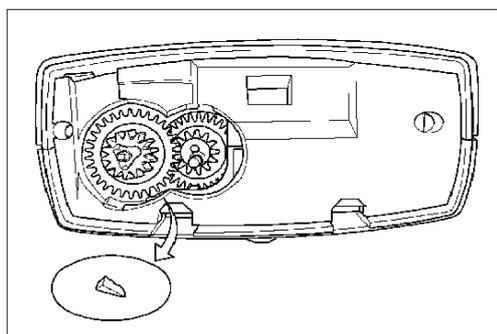
Le remplacement de la roue dentée endommagée est maintenant possible.
