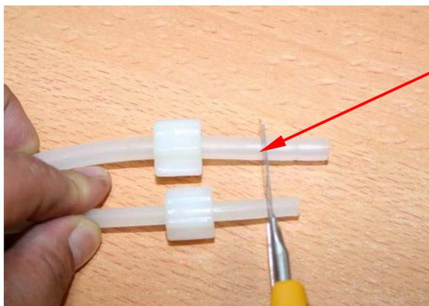
**Etape 5 :** Couper le bout du tube d'arrivée d'eau et retirer l'écrou en métal.
