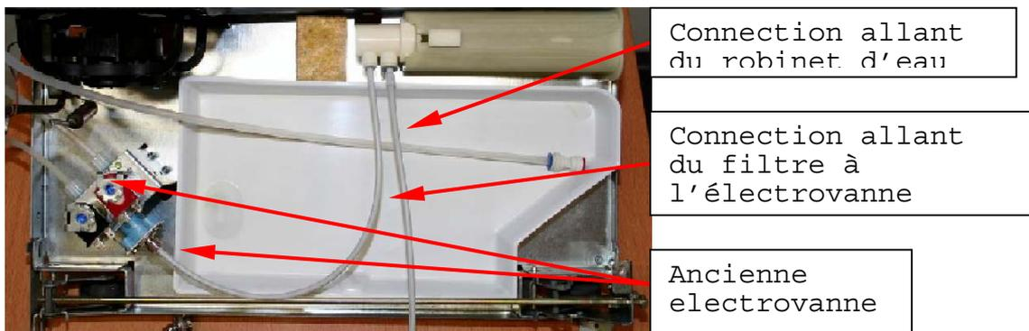
**Etape 1 :** Retirer les 2 écrous de connexion de sortie d'eau de l'électrovanne
