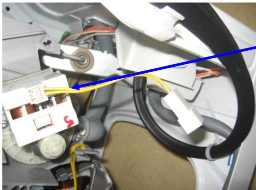
Monter la pompe équipée de sa bretelle filerie sur la cuve.
