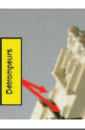
Le connecteur du câblage d'alimentation du module de puissance de ces lave-vaisselle est doté de 2 détrompeurs.
