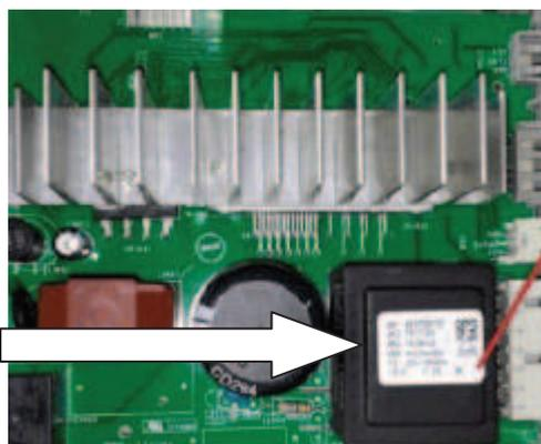
ATTENTION : l'ancienne version de la carte d'alimentation moteur ne peut être utilisée que sur les lave-linge de production avant 2013, équipés de l'ancienne version du moteur induction
