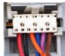
ATTENTION : l'ancienne version du capteur avec 6 fils, ne peut être utilisée que sur les lave-linge de production **avant** 2013 équipés de l'ancienne version du moteur induction
