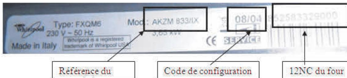
Si le code de configuration est comme dans l'exemple ci-dessus 08/04 il s'agit d'un four 6<sup>ème</sup> sens. Le code 08 correspond au code de configuration de l'afficheur Navigator (code UI) et le code 04 au code de configuration de la platine de puissance Antares (code AM)
