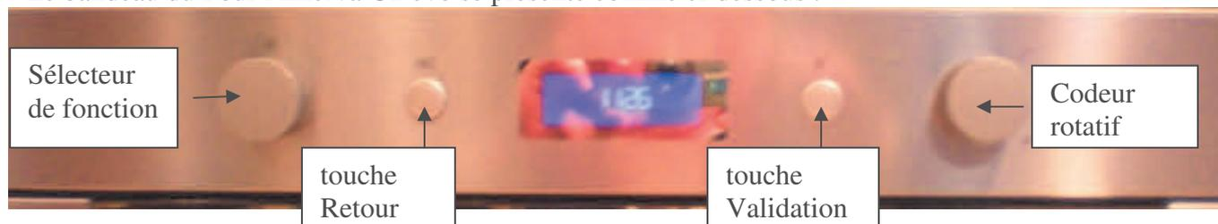
Les fours avec N° de série jusqu'à **140931xxxxxx** n'ont pas la possibilité d'être reprogrammés ; pour accéder à la configuration il est nécessaire de changer la platine de puissance et d'affichage. Pour les fours dont le N° est supérieur ou égal à **140932xxxxxx** on peut accéder au menu de configuration.
