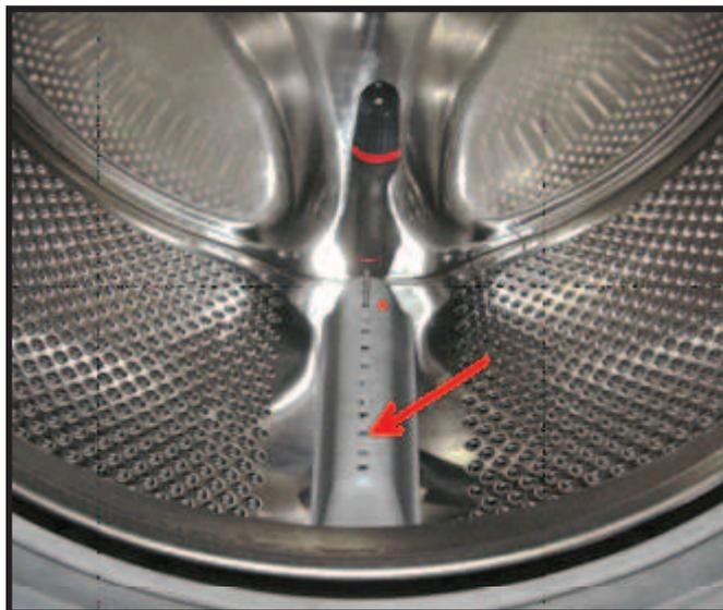
2 - Avant de remonter les aubes, il est nécessaire de repositionner à l'aide d'un tournevis les guides métalliques du tambour. (voir photo)
