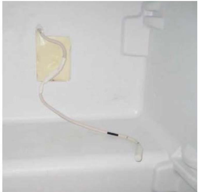
Réduire le câble à une longueur de 90mm, dénuder et connecter en utilisant les connecteurs fournis dans le kit, lequel câble doit être raccourci à la longueur appropriée.
