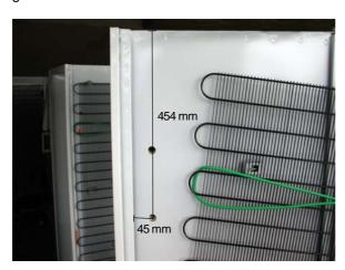
Il est possible que sur certain appareils le trou de l'unité de contrôle ancienne soit approprié même pour la nouvelle. Por les produits restants, il faut vérifier dedans l'habillage le point où l'unité de contrôle doit ètre fixée. Marquer le point pour le trou, percer par l'intérieur et déplacer la douille selon le point 2.
