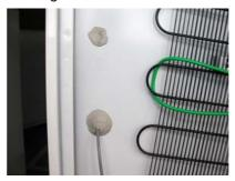
8. Inserer le capouchon (E) dans le trou ancien et monter le rebord (G). Ne pas oublier de remettre au client les nouvelles instructions, marquées "Pour le client"!
