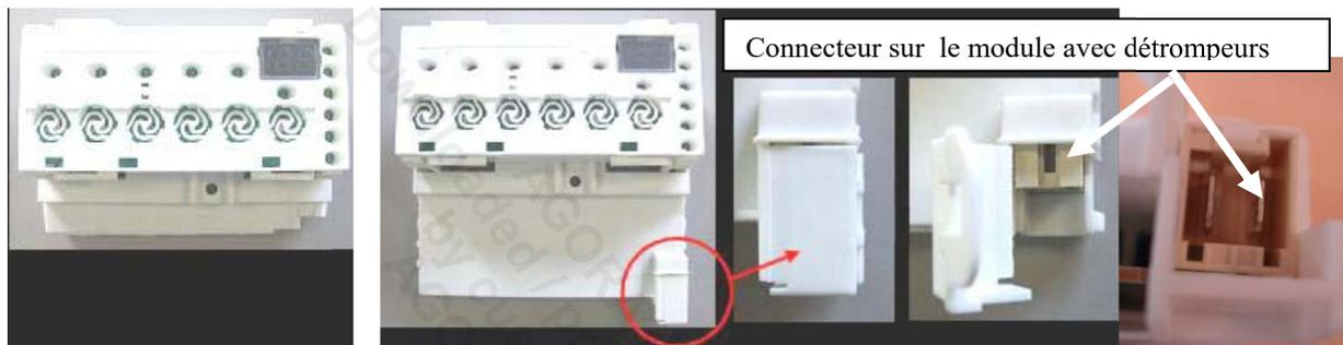
ATTENTION : Le connecteur du câblage d'alimentation du module de puissance de ces lave-vaisselle est doté de 2 détrompeurs.
