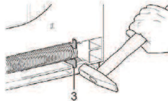
Positionner correctement le support plastique dans le socle.
