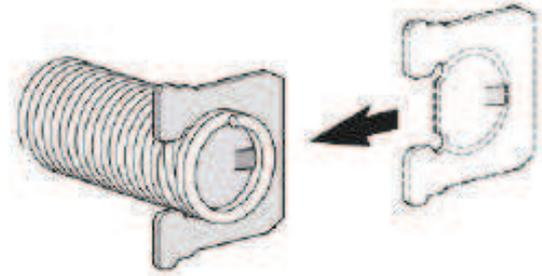
Insérer la plaque support métallique (3) sur le socle à l'aide d'un marteau.
